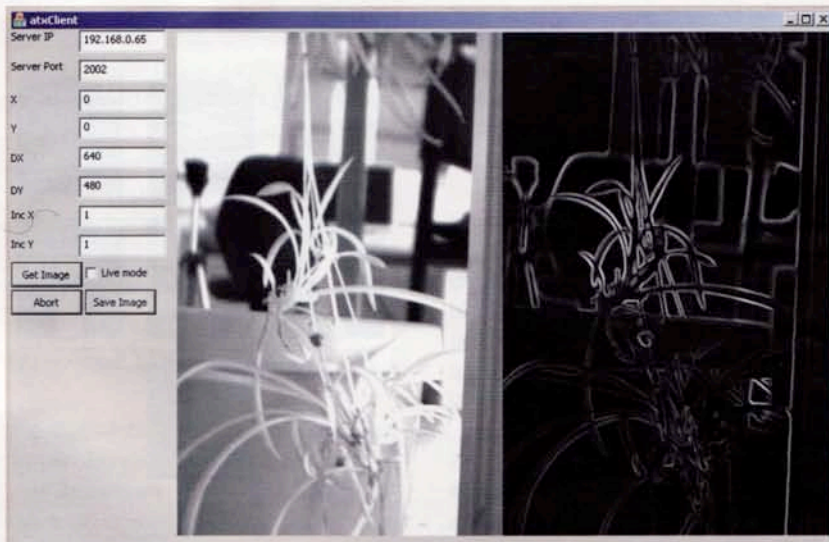
Bild 3. Ausgabe der Beispiel-Applikation, Visualisierung mittels AtxClient (vgl. Text).
